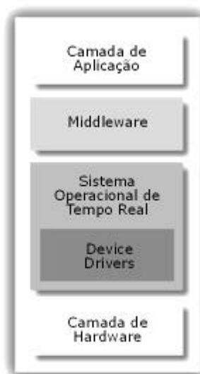
Figura 1: As diversas camadas típicas de um set-top box.
